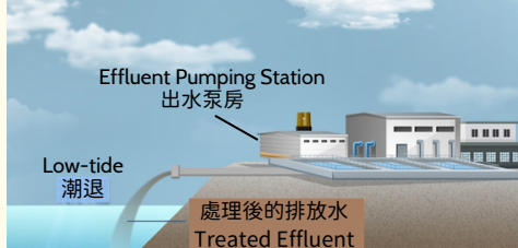
元朗淨水設施出水泵房運作示意圖
